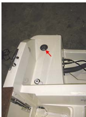
Nable Accès : Arrière tribord
