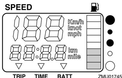
L'indication de niveau de carburant peut manquer de précision selon la position du capteur dans le réservoir de carburant et l'attitude du bateau sur l'eau. Si vous naviguez avec le trim réglé pour relever la proue ou en virages continuels, la jauge pourra donner de fausses indications.
