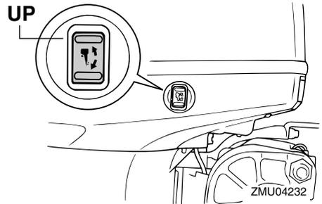
2. Appuyez sur l'interrupteur de trim "UP" (relever) jusqu'à ce que le moteur hors-bord soit complètement relevé.
