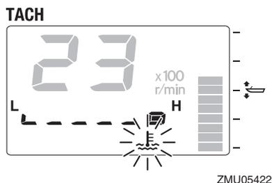
Arrêtez immédiatement le moteur si le vibreur retentit et si l'indicateur d'alerte de faible niveau d'huile clignote. Vérifiez la quantité d'huile moteur et faites l'appoint si nécessaire. Si le dispositif d'alerte est activé alors que la quantité d'huile appropriée est maintenue, consultez votre revendeur Yamaha.
