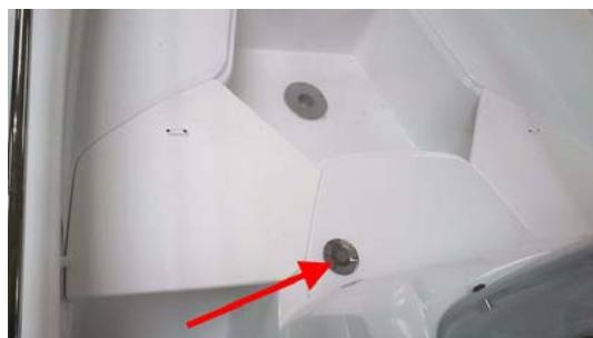
Nable de remplissage
