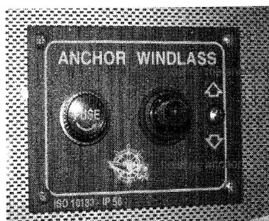
Maintenir le commutateur enfoncé vers le haut provoque le déroulement de la chaîne – l'ancre descend dans l'eau.
